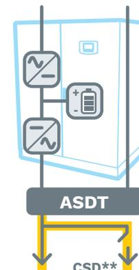
C, une partie de la charge est alimentée sans interruption tandis que le reste n'est alimenté qu'en cas de panne de courant grâce au dispositif CSD (toujours alimenté + sortie d'urgence uniquement « AS+EO »).
