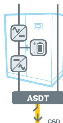
B, l'équipement comprend un ou plusieurs dispositifs de commutation (CSD), qui dépendent de la disponibilité de l'alimentation électrique normale. En cas de panne d'alimentation électrique, le dispositif CSD connecte la charge qui n'était pas alimentée jusqu'à ce moment (sortie d'urgence uniquement « EO »).
